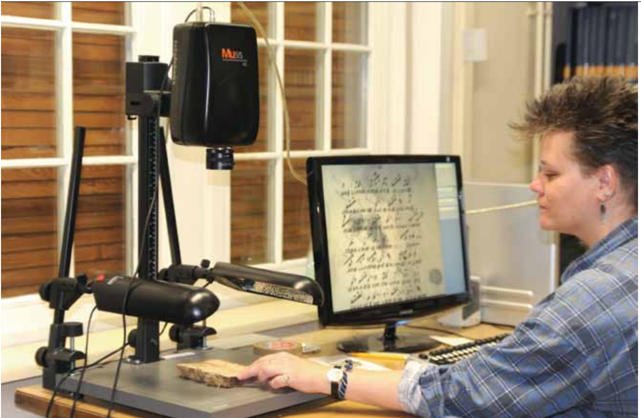
Einsatz der Multispektralkamera zur Sichtbarmachung getilgter Textstellen
