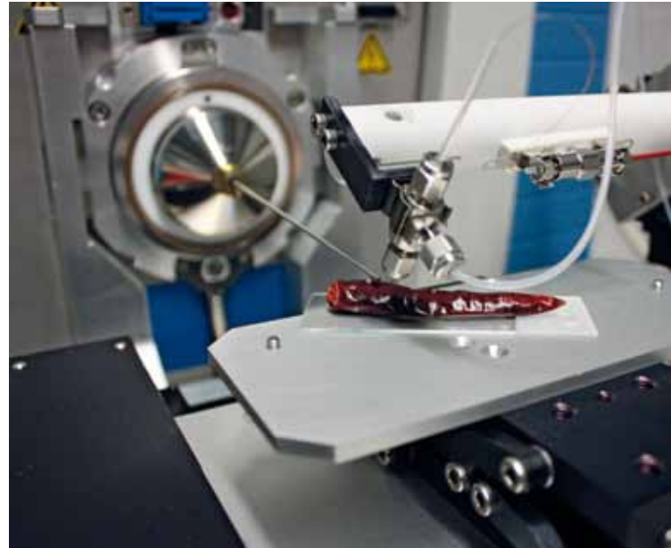
Direkte massenspektrometrische Oberflächenanalyse von Pflanzenmaterial
